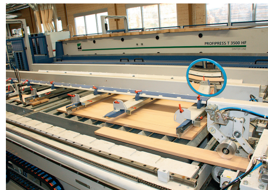
Herzstück der Plattenfertigung ist die Profi-Press T 3500 HF von Dimter
