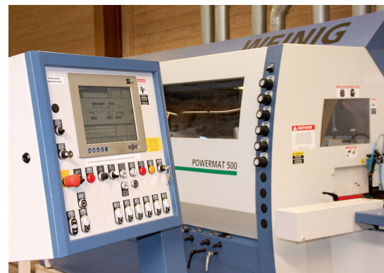
Der erste Schritt: Die Lamellen werden mit dem Weinig-Powermat 500 gehobelt
