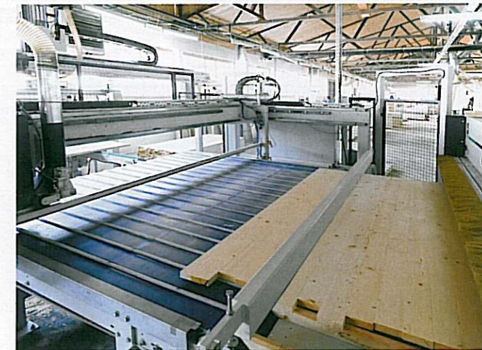
Nach der Endlosverleimung wird der Strang sofort längs und quer formatiert und die fertigen Massivholzplatten werden abgestapelt
