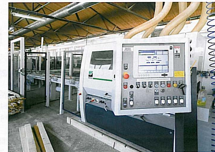
Die Powermat 500 wird aus einem Aufgabepuffer automatisch mit Schnittholz beschickt und sichert die kontinuierliche Pressenbeschickung
